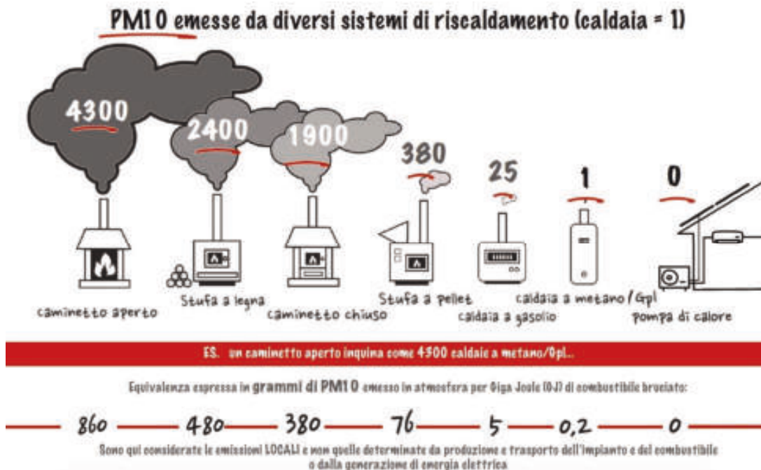
Fig. 73: Emissioni di PM10 (t/a) nel 2017 per tipologia di apparecchio di combustione di biomassa ad uso di riscaldamento residenziale e FE di PM10 per differenti tipologie di apparecchi di combustione (g/Gj)
