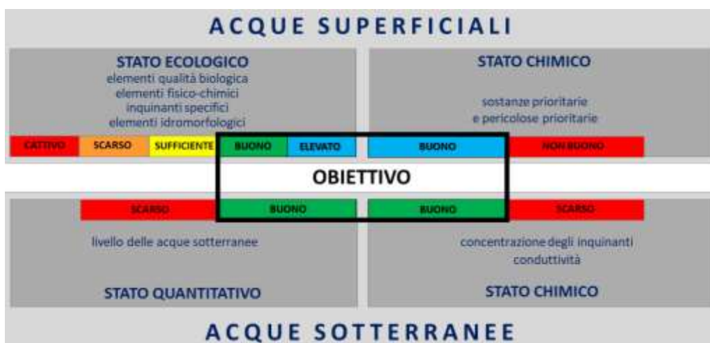
Figura 4 - Valutazione dello stato delle acque superficiali e sotterranee al fine del raggiungimento dell'obiettivo di buono stato secondo la Direttiva 2000/60/CE.
