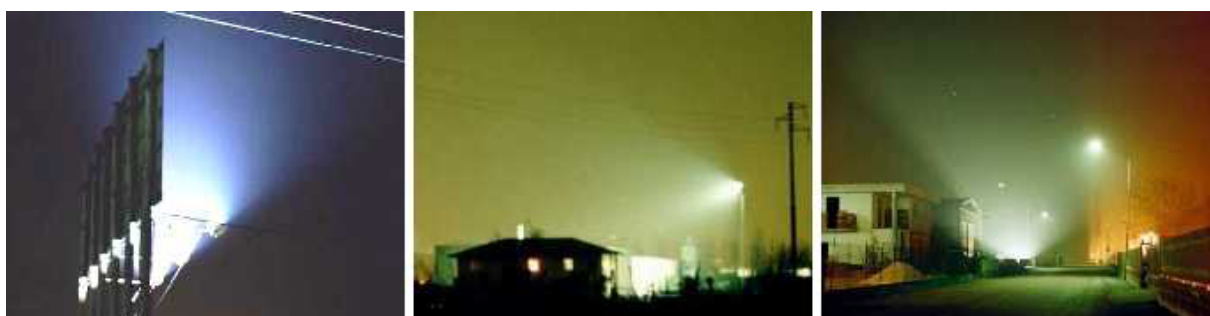
Fig.1 - Tipici esempi di dispersione di luce ingiustificata verso il cielo o dove non richiesta [Immagine fornita da CieloBuio]
