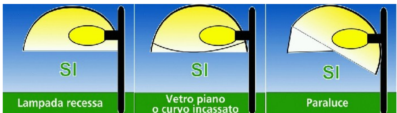
Fig. 2 - Tipologie di apparecchi conformi alla L.R. 19/2003
