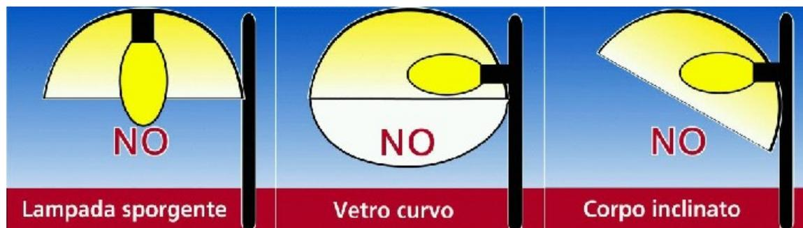
Fig. 1 - Tipologie di apparecchi non ammessi dalla L.R.19/2003
