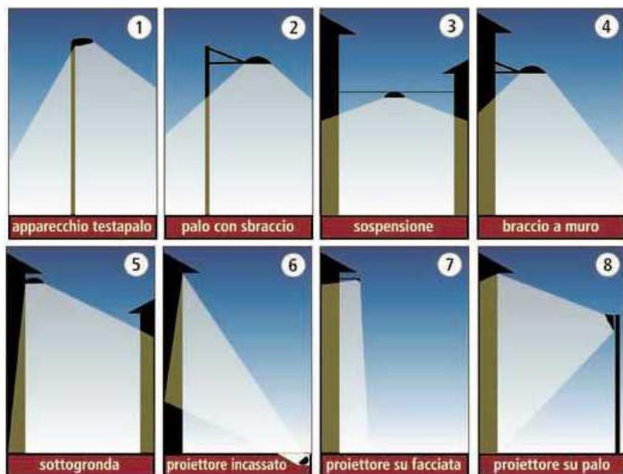
Fig. 6 - Impianti di illuminazione conformi alla L.R. 19/2003. Le installazioni di cui al punto 6 ed 8 sono ammesse esclusivamente per manufatti di particolare e comprovato valore storico ove non sia possibile illuminarli dall'alto verso il basso. [Immagine fornita da CieloBuio]
