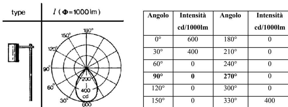
Fig. 2 - Curva e dati fotometrici di un apparecchio a forma cilindrica. [Immagine fornita da CieloBuiro]
