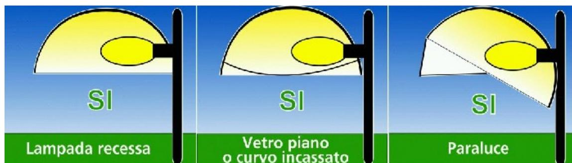
Fig. 2 - Tipologie di apparecchi conformi alla L.R. 19/2003
