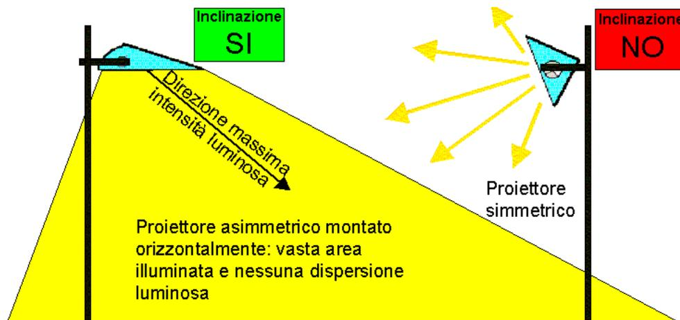
Fig. 12 - Gli apparecchi simmetrici ed asimmetrici se posti con vetro piano orizzontale sono ugualmente conformi alla L.R. 19/2003. Gli apparecchi asimmetrici sono fatti per essere installati orizzontali e compensare con la loro asimmetria, l'inclinazione con cui si installano quelli simmetrici. [Immagine fornita da Cielobuio]
