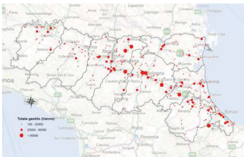
Figura 27 > Impianti di gestione di rifiuti da costruzione e demolizione in regione, nel 2010
