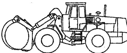
Esempio di caricatore a ruote con pinza
