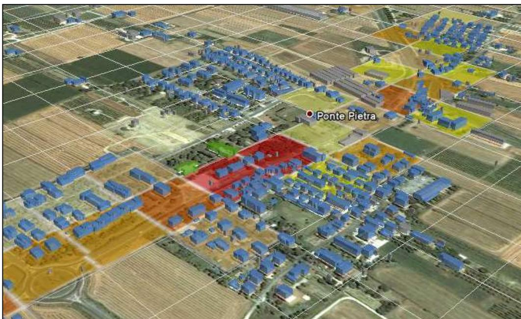
Figura 5 – Aggregazione dell'indicatore globale di criticità  $ECU_{den}$  dei singoli edifici su una griglia a maglia quadrata 100 x 100 m in prossimità di una strada provinciale.
