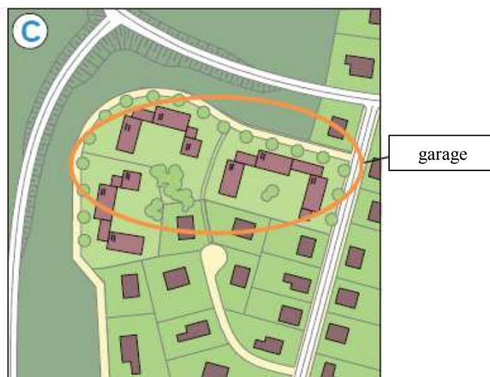
Figura 11 – Garage utilizzati come schermo al rumore per formare una corte protetta dal rumore stradale (da [77]).
