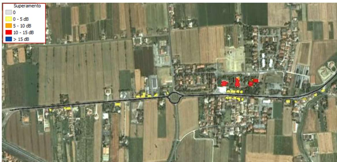
Figura 21 – Identificazione degli edifici per i quali i valori limite sono superati; indicatore  $L_{den}$ .
