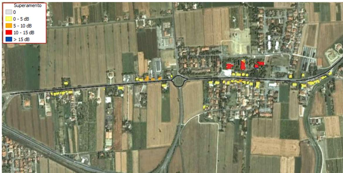
Figura 22 – Identificazione degli edifici per i quali i valori limite sono superati; indicatore  $L_{night}$ .
