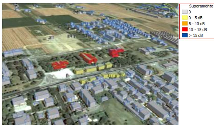
Figura 17 – Superamenti dei valori limite per singoli edifici, espressi tramite l'indicatore  $L_{den}$ .
