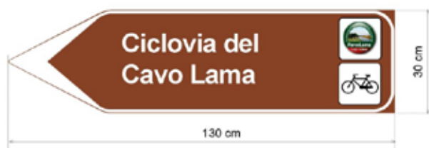
Fig 4: Segnale di direzione per avviamento a Ciclovie del Cavo Lama ottenuto dai segnali turistici per contesti extraurbani (Tabella II 14a DPR 495/92)
