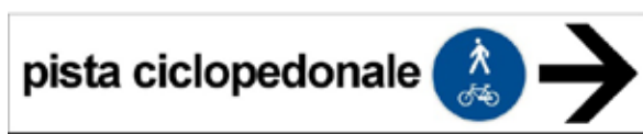
Fig 1a: Segnale "piccolo" di direzione urbano composto da fig. tab II 13/a e fig. II 92b art. 122 DPR 495/92)
