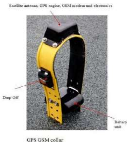
Figura 4. Il collare GPS/GSM Pro-Light4 (Vectronic Aerospace®)
