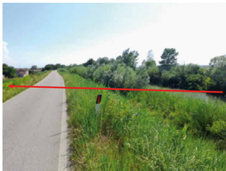
Foto 1: Attraversamento S.P. N.68 ed adiacente Fiume Montone, contro senso gas (in rosso l'andamento qualitativo della tubazione in TOC)
