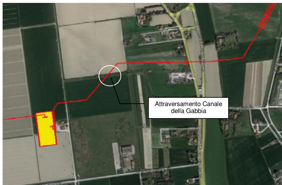
Figura 2.3: Stralcio con foto aerea dell'ubicazione dell'attraversamento del Canale Irriguo Diramatore "Canale della Gabbia" con il metanodotto in progetto (in rosso)
