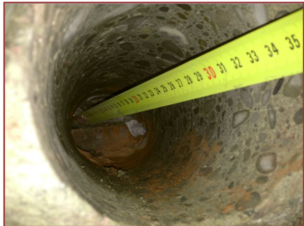
Foto 8: Prova su catena: foro carota diam. 10 cm
