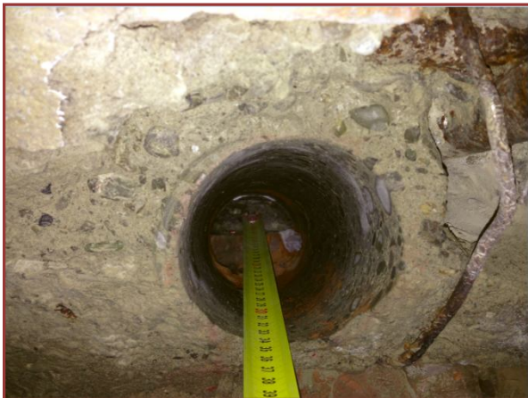
Foto 7: Prova su catena: foro carota diam. 10 cm
