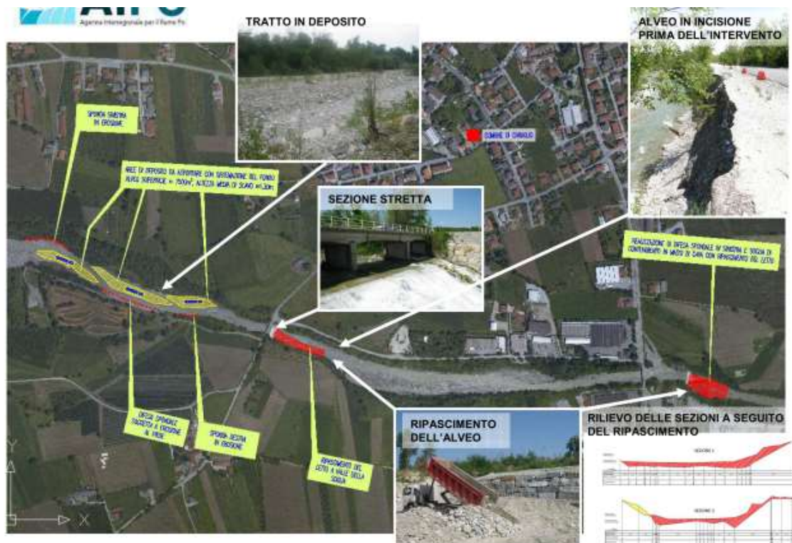
Figura 44 - Esempio di ripascimento di un tratto fluviale in erosione, tramite movimentazione di materiale litoide costituente depositi presenti nei tratti più a monte.
