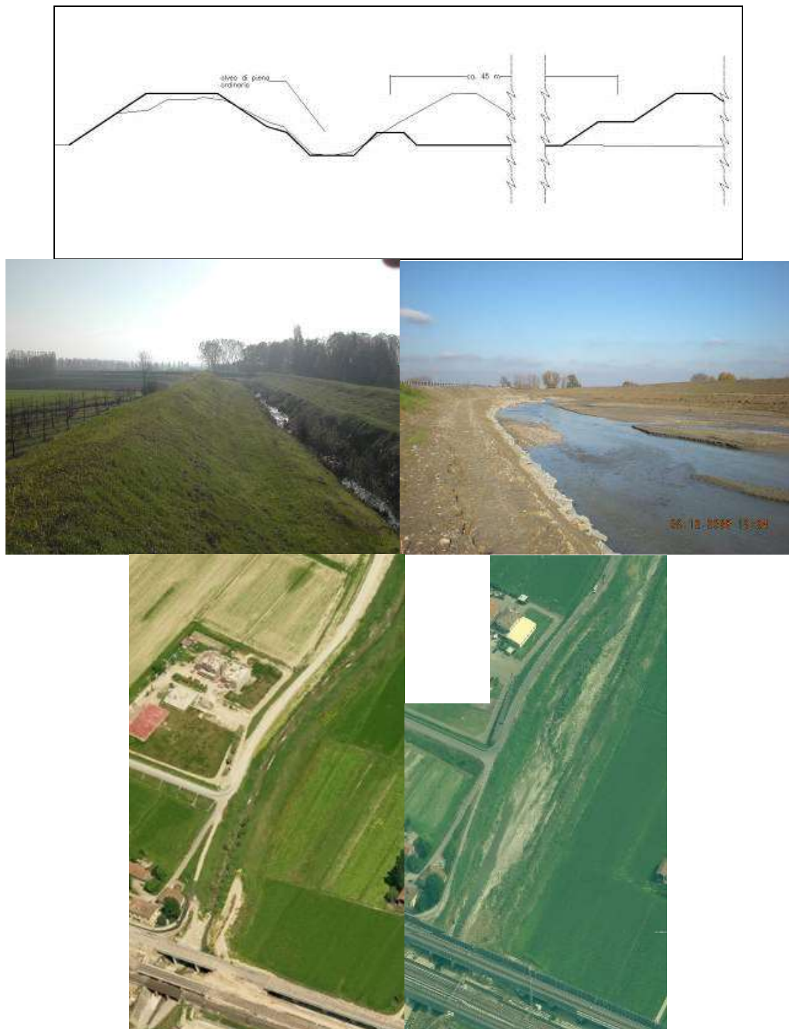
Figura 8 - Esempio di arretramento arginale lungo il torrente Lavino, in comune di (Provincia di Bologna). Il torrente Lavino nasce in Comune di Monte San Pietro, dopo un percorso collinare, entra in pianura in prossimità della via Emilia, nel Comune di Zola Predosa, per poi immettersi nel torrente Samoggia, di cui è il principale affluente, in località Forcelli. A
