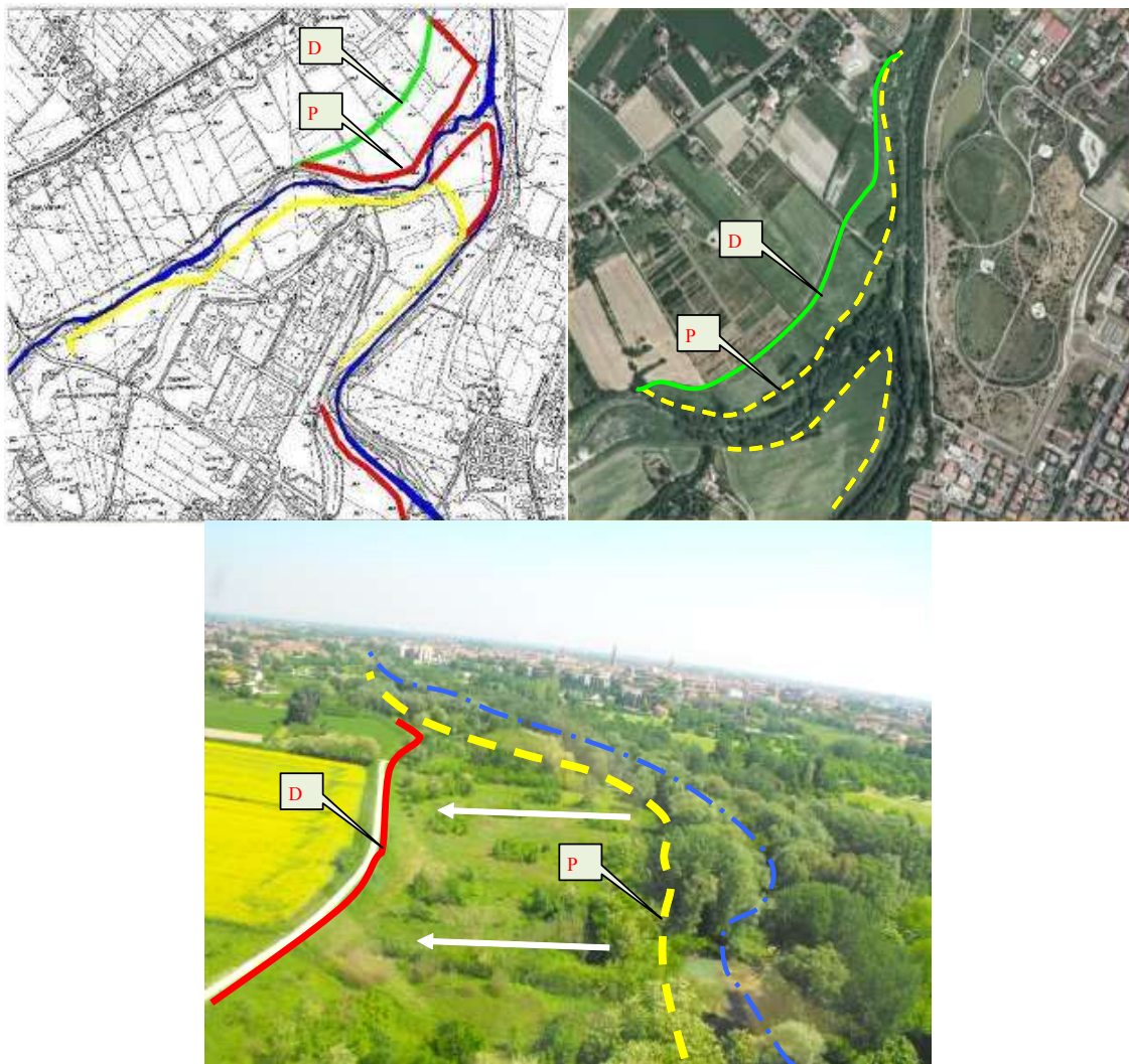
Figura 3 – Esempio di arretramento arginale sul fiume Montone a difesa della città di Forlì.
