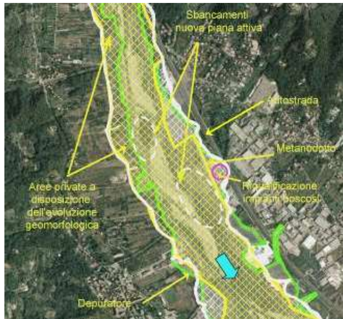
Figura 52 – Con riferimento allo studio dell’Autorità di Bacino del Magra riportato nella figura precedente, l’immagine permette di comprendere le modificazioni apportate alla fascia di mobilità funzionale definita su soli criteri geomorfologici una volta considerati gli aspetti di natura territoriale-urbanistica, al fine di definire la fascia di mobilità funzionale “compatibile”. Si osservi in particolare come in questo esempio la fascia di mobilità non si limiti alle sole aree demaniali e come siano previsti anche interventi per riattivare più velocemente alcuni processi geomorfologici. Linea bianca: confini della “Fascia di mobilità funzionale” derivante dalla fase di studio geomorfologico; linea gialla: confini della “Fascia di mobilità funzionale compatibile” di progetto, dopo la fase di mediazione con gli Enti (coincide con la linea bianca ove non vi siano state variazioni durante la fase di mediazione); linea verde: confine delle aree demaniali (si noti che la fascia di mobilità funzionale comprende anche aree non demaniali); la freccia azzurra indica la direzione della corrente. Gli ovali tratteggiati indicano aree in cui realizzare lembi di piana alluvionale, mediante sbancamenti e rivegetazione, per accelerare il riequilibrio morfologico. (Fonte: Centro Italiano di Riquilibrato Fluviale CIRF).
