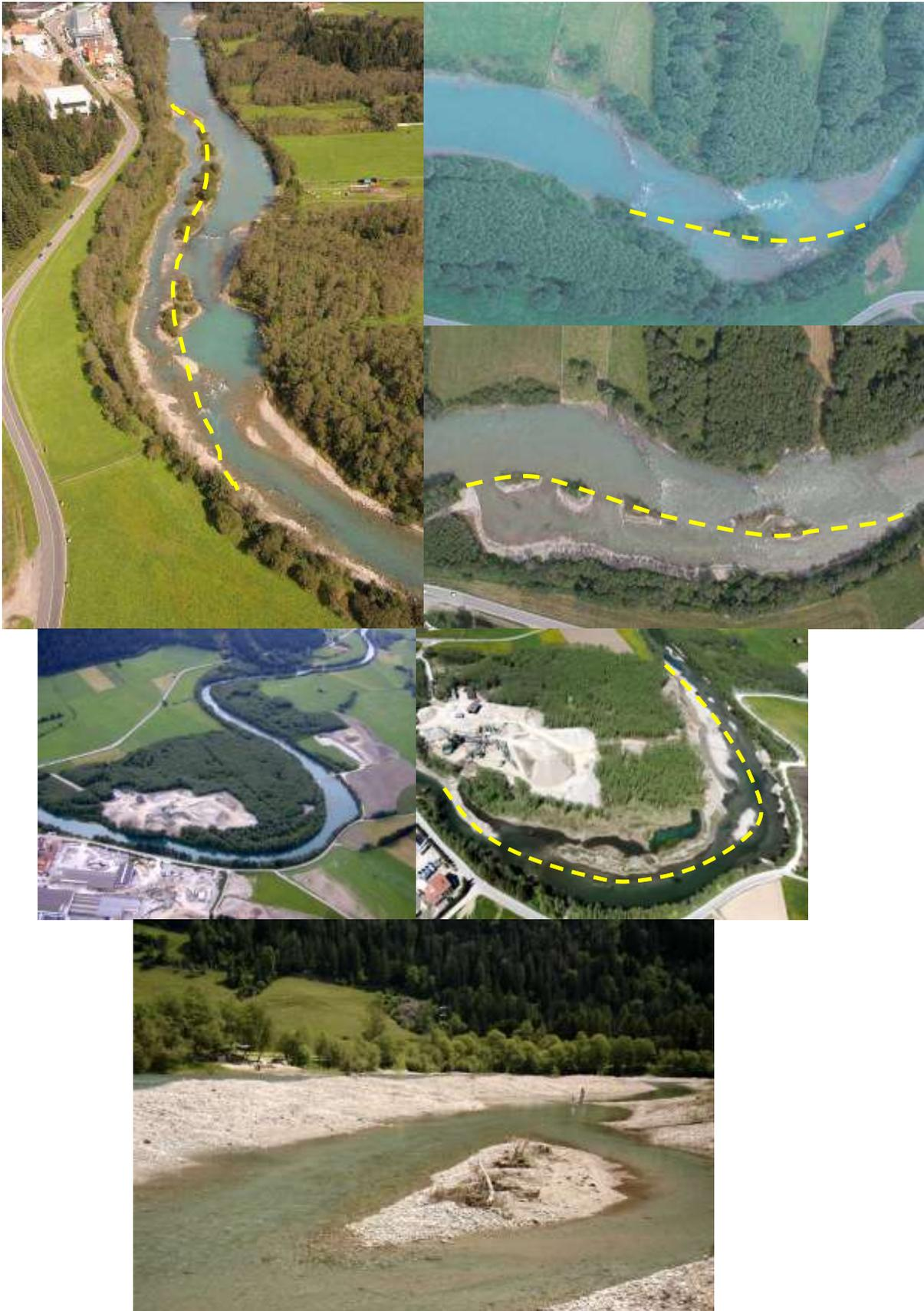
*Figura 22 – Esempio di rimozione di difese spondali e allargamento di sezione.
