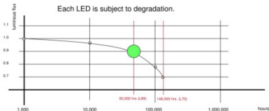
I produttori LED, in base alle indicazioni contenute nei documenti IEC, devono fornire, oltre all'indicazione della perdita percentuale di flusso nel tempo, anche l'indicazione del *failure rate* relativa ad ogni diodo luminoso (ovvero quale percentuale della popolazione dei diodi mantiene il flusso luminoso indicato); in generale l'indicazione riporta la percentuale di flusso residua dopo un determinato periodo e la percentuale di diodi che mantengono le caratteristiche indicate senza rompersi.
