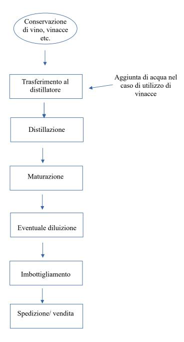
B.7.2.2. Diagramma di flusso della produzione di acquavite ottenuta dalla fermentazione interna al distillatore
