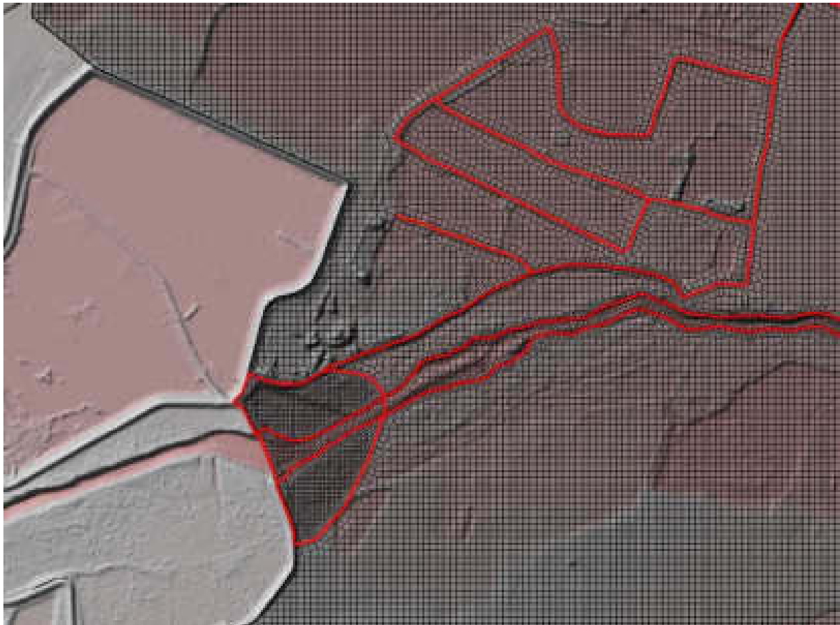
Figura 4. Dettaglio dello schema di discretizzazione del dominio di calcolo con “ mesh ” non strutturata. Le linee in rosso rappresentano le “ break-line ”.
