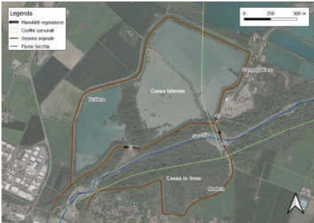
Figura 1. Il sistema della cassa di espansione del fiume Secchia. (A) indica il manufatto di sbarramento trasversale; (B) la soglia che consente l'alimentazione del comparto in derivazione e (C) il canale di scarico di quest'ultimo.
