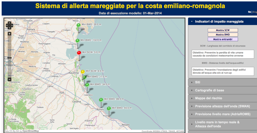
Figura. Esempio di pagina web del sistema di previsione degli impatti prodotti dalle mareggiate. Questo sistema opera in modo integrato con i modelli di previsione di onda e di livello del mare gestiti da ARPA-SIMC ( http://geo.regione.emilia-romagna.it/schede/micore ). I “valori soglia” dei parametri meteo-marini da utilizzare nelle procedure di allertamento costiero sono ricavati dall’analisi statistica delle serie storiche dei dati meteo-marini e dall’analisi delle mareggiate storiche impattanti nel periodo 1946-2010. Il sistema di allerta delle mareggiate necessita di aggiornamenti periodici per definire le soglie delle mareggiate considerate impattanti.
