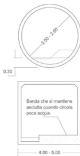
Figura. Esempio schematico di adattamento di tombini di drenaggio e scolarari idraulici per il passaggio della fauna (da Rivella, UTET Scienze Tecniche e Arpa Piemonte).
