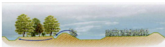
Figura. Esempio schematico di risezionamento dell'alveo con creazione di golena vegetata su una sponda.
