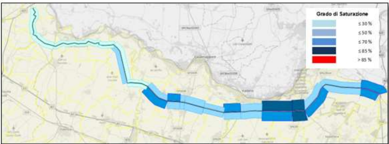
Grado di Saturazione Veicoli Equiv. media 7:00 – 9:00 Scenario Programmatico PRIT2025 – Asse Cispadana Ordinaria
