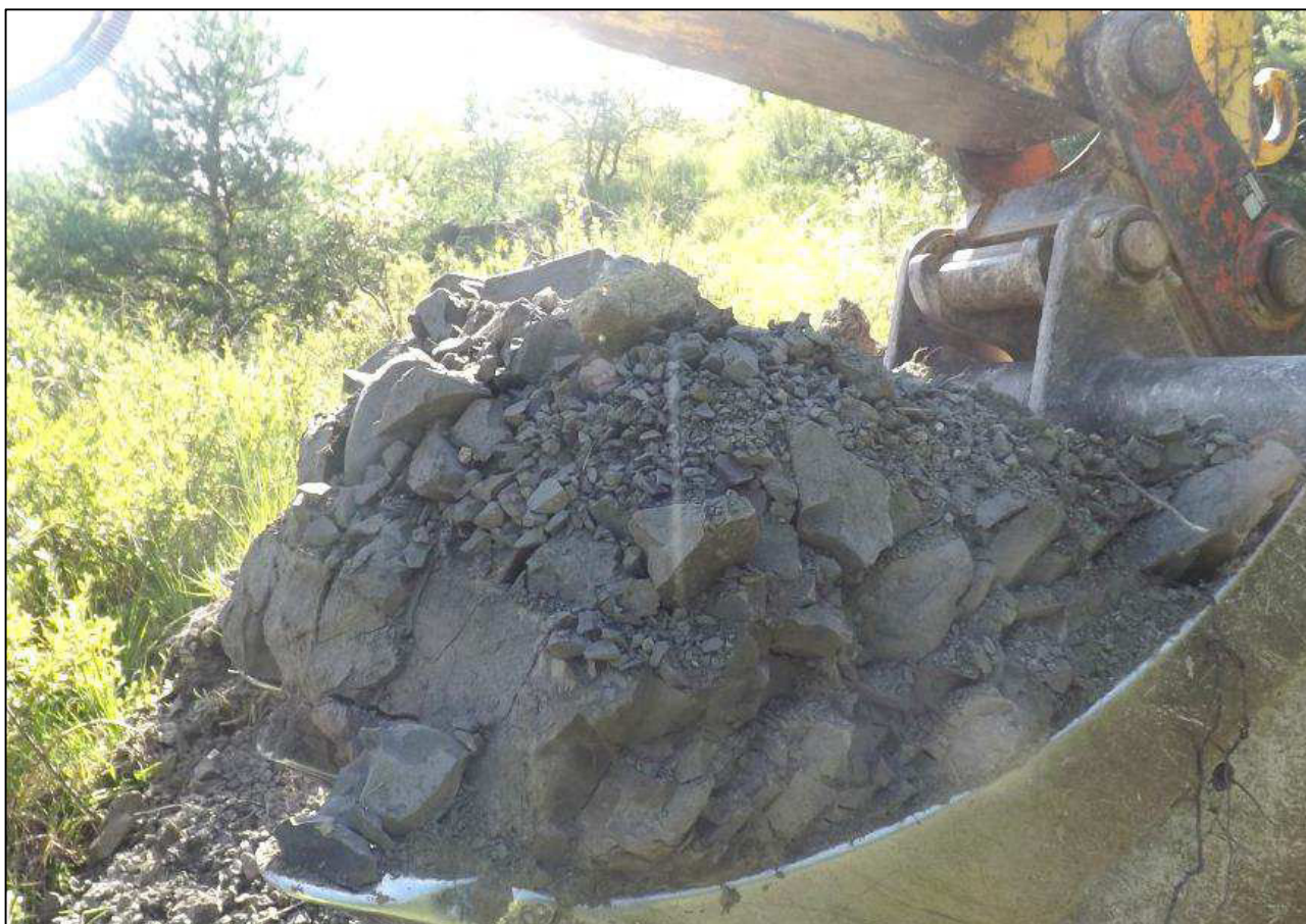
Foto n° 4 – particolare delle marne del substrato
