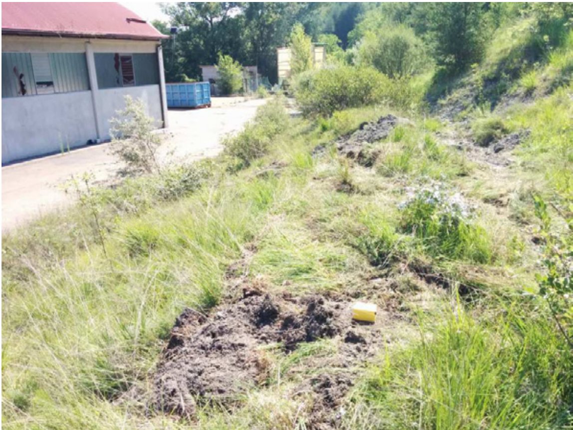
Foto n° 6 – misura HVSR a stazione singola
