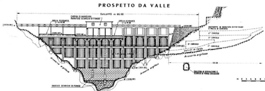
Figura 2 – sezione longitudinale dello sbarramento
