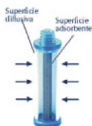
Figura 12: Campionatore a diffusione radiale – Radiello
