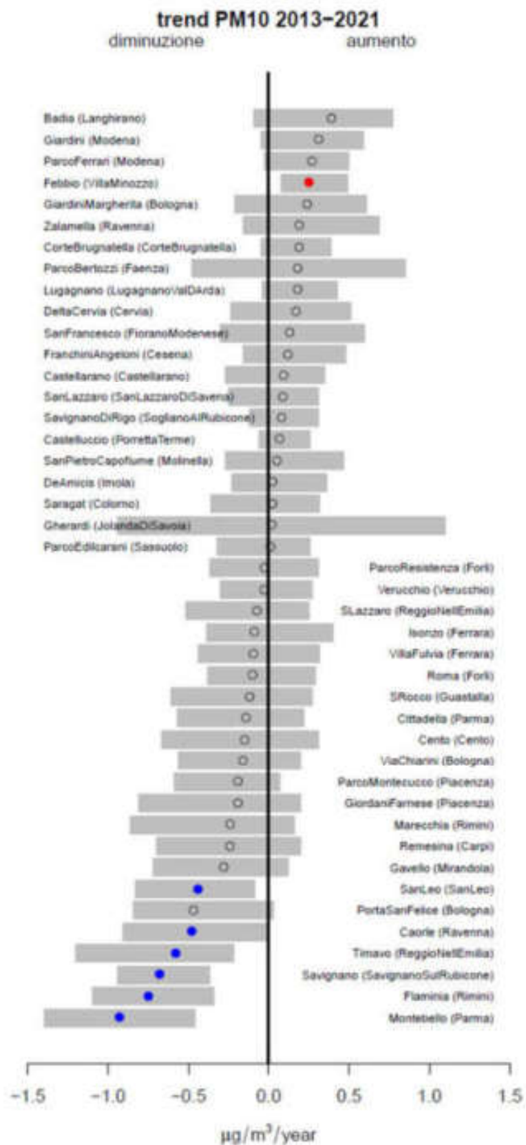
Figura A3.1. Trend PM 10 2013 – 2021. Stima del trend delle concentrazioni giornaliere di PM 10 , calcolato per ciascuna stazione di misura sui dati delle stazioni di monitoraggio selezionate disponibili nel periodo 2013-2021. I cerchietti indicano il trend, il colore esprime la significatività statistica (blu=diminuzione significativa; rosso=aumento significativo; grigio=trend non significativo). La barra grigia identifica l'intervallo di confidenza del 95%
