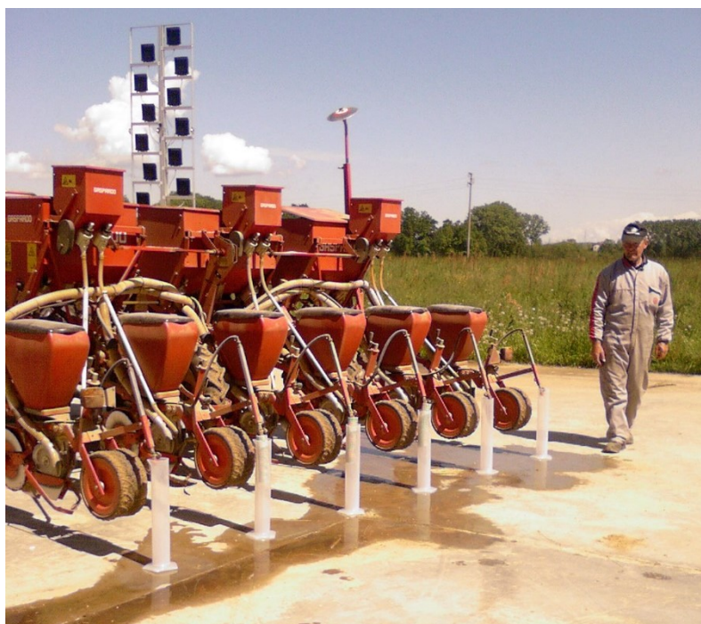
Controllo funzionale e regolazione strumentale di una irroratrice abbinata a seminatrice
